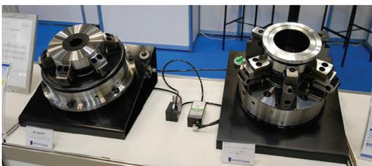
大型ダイアフラムチャック「DF-CHUCK」(ダイナミックツール)
